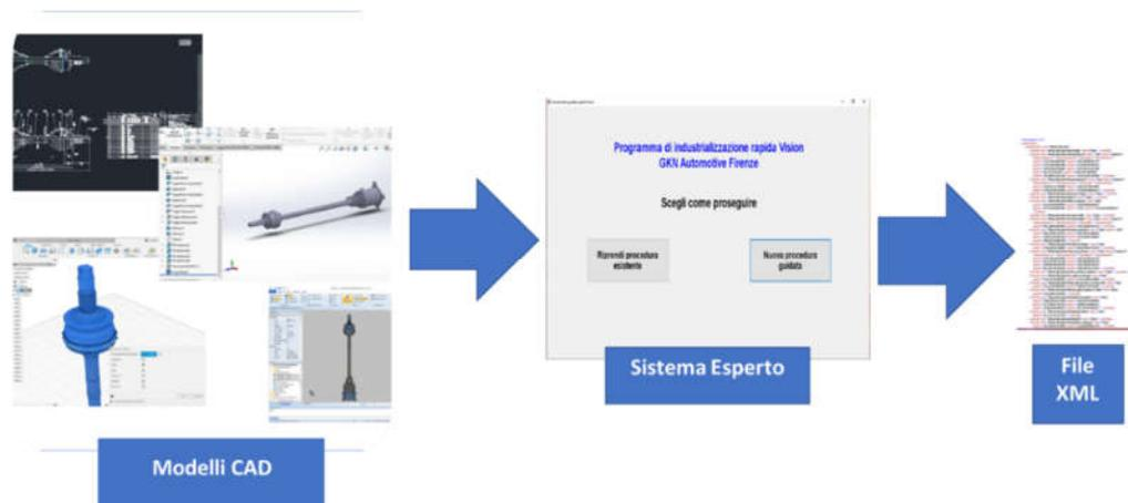
Figura 7: Flusso d'estrazione d'informazioni geometriche e dimensionali da modelli CAD
