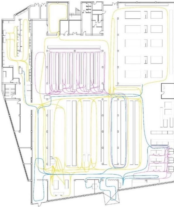
Figura 2: Planimetria Magazzino-Reparto di tagli con Spaghetti Chart – as is
