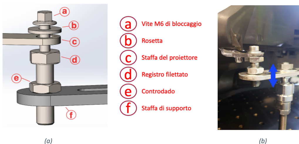
Figura 4.1 – Modello 3D del registro di montaggio (a); Registro di montaggio reale (b).
