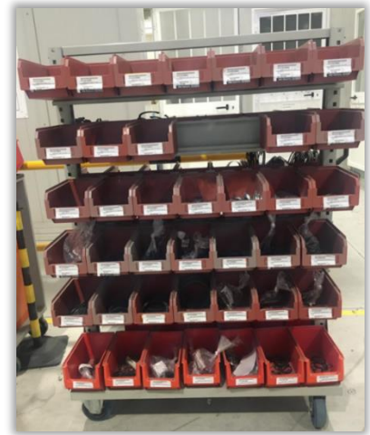
Figura 7. Esempio di carrello Kanban implementato in produzione
