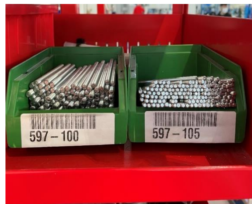
Figura 5 - Barre filettate a misura nella cella "Asse Z"
