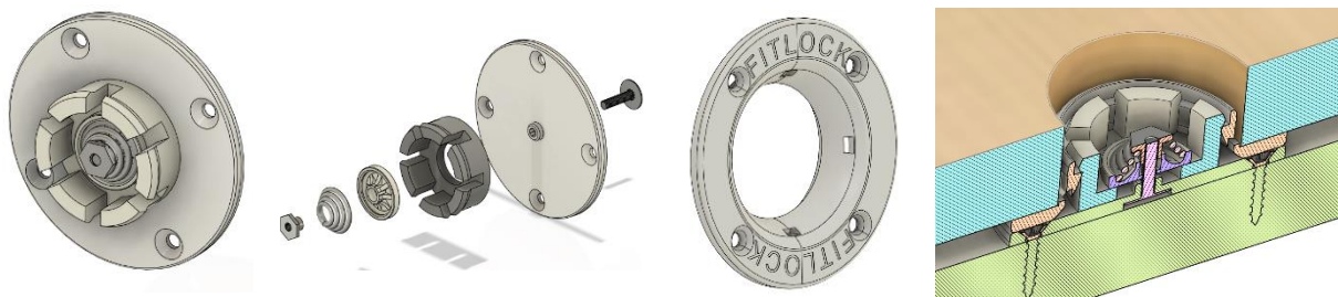
Figura 1-1 A sinistra l'aggancio maschio ed suo esploso. Sulla destra l'aggancio femmina ed una sezione dei due elementi montati e accoppiati.
